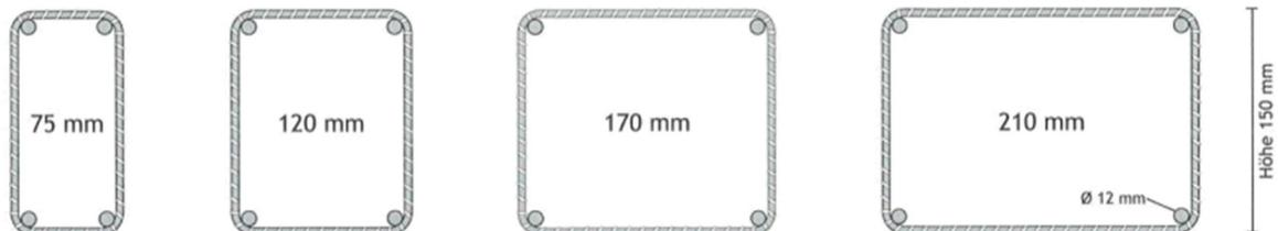
Betonstahl BST 500 A/B geschweißt als „Nichttragende Schweißverbindung“ gem. DIN EN ISO 17660-2
